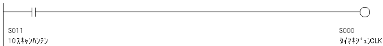
図6 タイムベースの設定にS11を使用する回路
